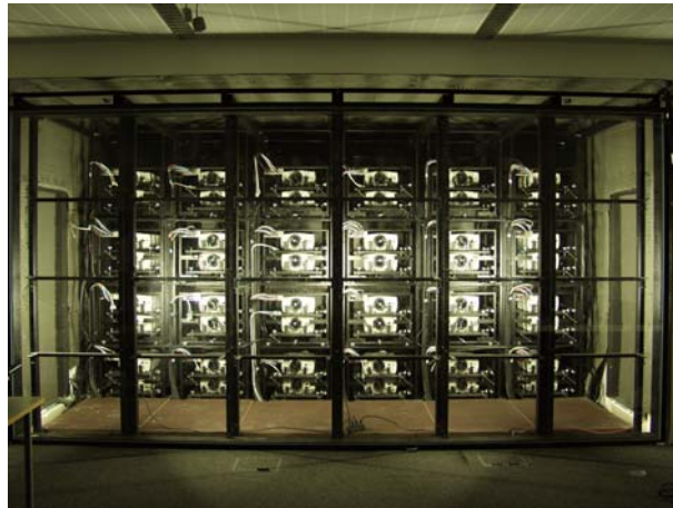
Abbildung 5.12: HEyeWall: 48 Projektoren leuchten die große Projektionsfläche aus.
