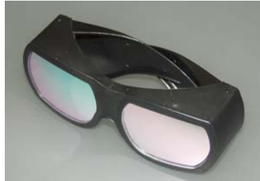
Abbildung 5.7: Stereobrille für das Infitec-Verfahren.
