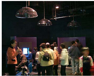
Abbildung 5.18: Soundtubes fokussieren den Sound auf einen bestimmten Bereich [18].
